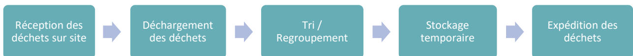
Figure 3 : Synoptique simplifié des activités de transit, regroupement, et tri mises en œuvre
