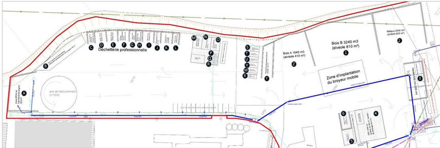
Figure 6 : Extrait du plan de masse du site indiquant les zones d'entreposage de déchets
