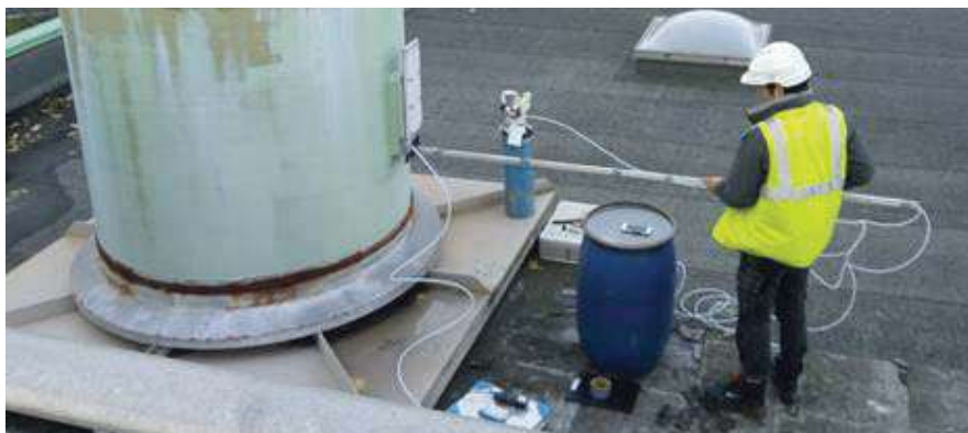
Echantillonnage sur source canalisée
