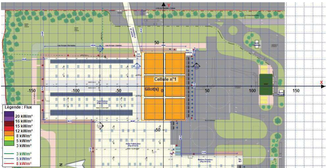
Figure 11 : Distance d'effet des flux maximum à une hauteur de cible de 5,8 m (décalée virtuellement à -3,2 m)
