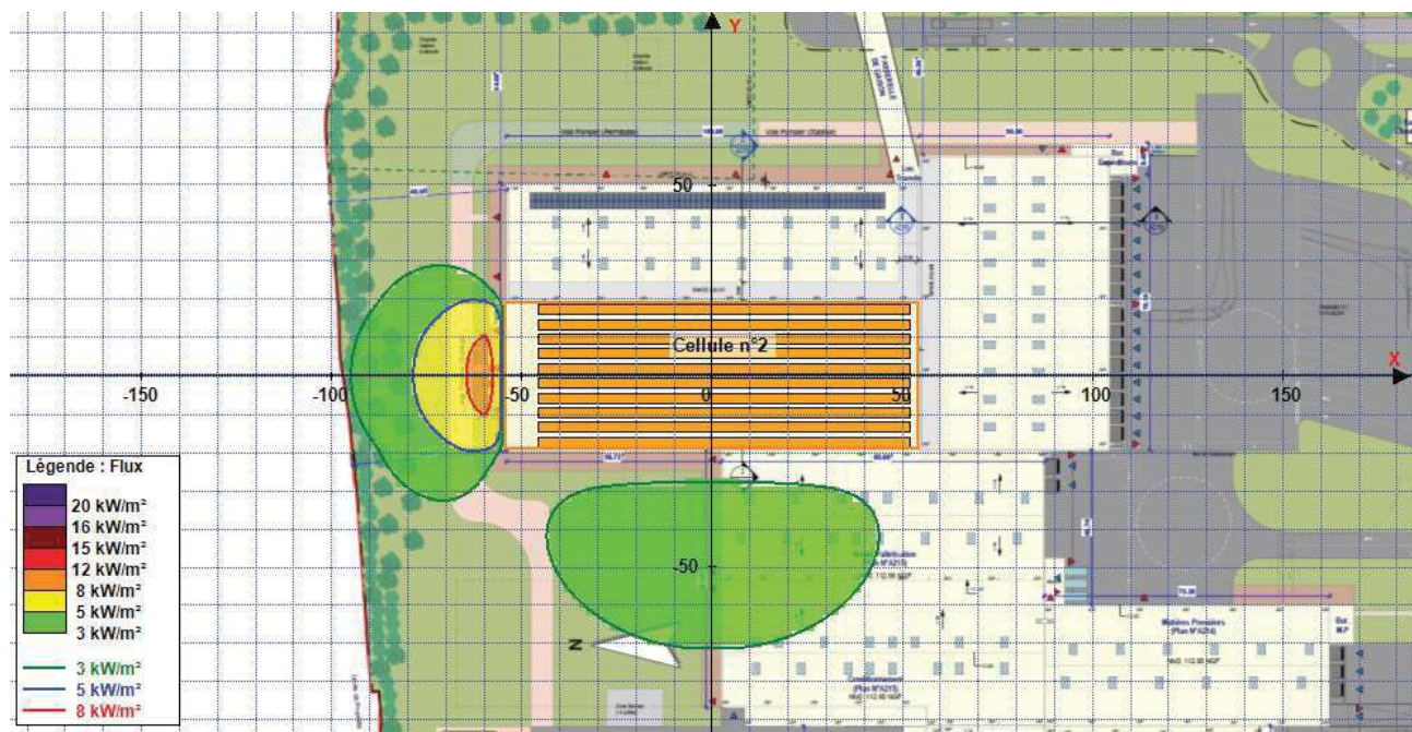
Figure 7 : Distance d'effet des flux maximum à une hauteur de cible de 1,8 m
