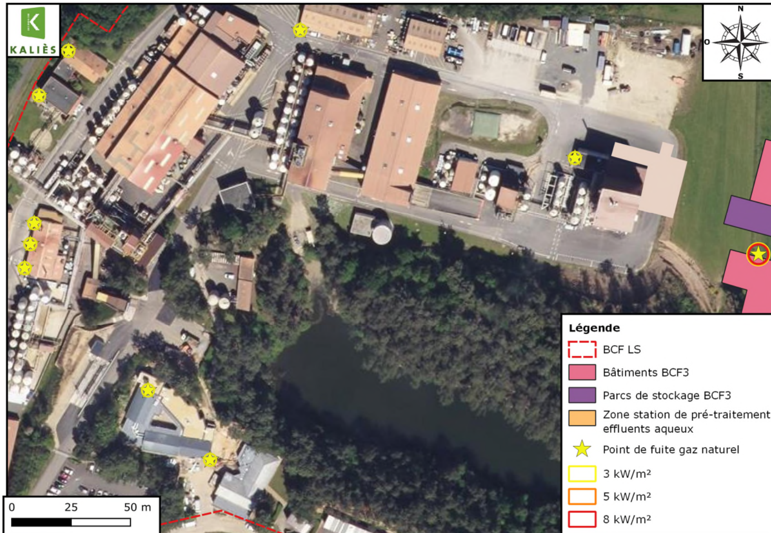
Figure 17 : Feu torche suite à une fuite de gaz naturel (condition F3/15)
