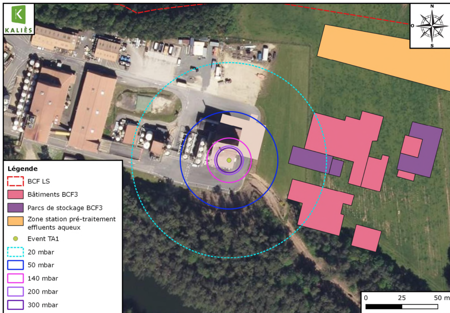
Figure 5 : Explosion au sein de la chambre d'atomisation de la TA1 - Effets à 17 m
