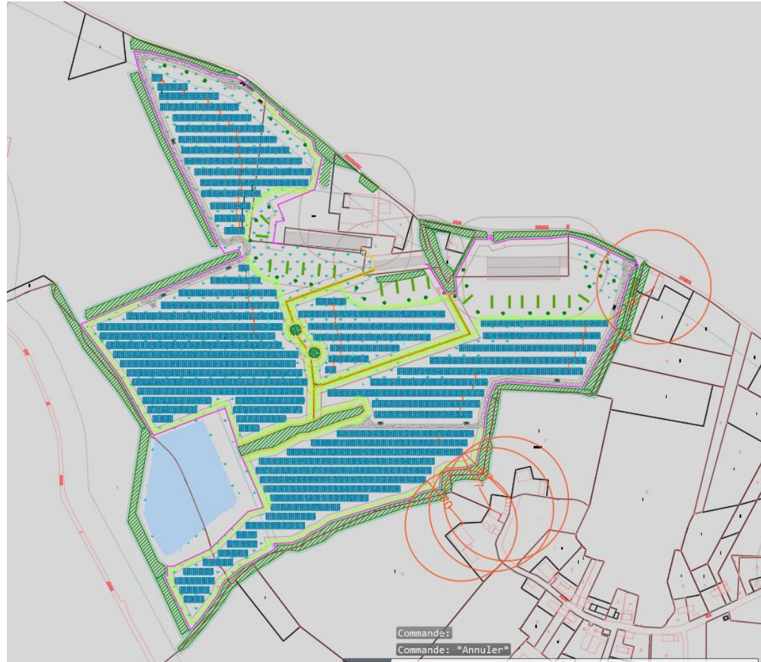
Figure 13: Distance entre les habitations et les onduleurs (>70m) – (Source : wpd)
