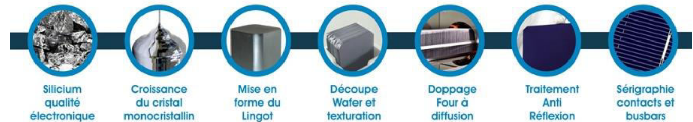
Figure 22 : Procédés de fabrication d'une cellule cristalline semi-conductrice de silicium (Jade Technologie, s.d.)
