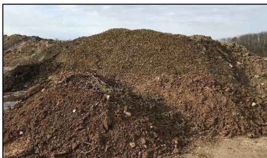
Fig. 11 : Exemple de mélange de déchets inertes pour le remblaiement de sablière
