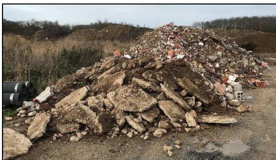
Fig. 10 : Exemple de matériaux de démolition pouvant être recyclés
