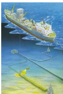
Figure 9 : Moyen maritime pour le placement des roches sur un câble (Source : VSMC in RTE, 2016)
