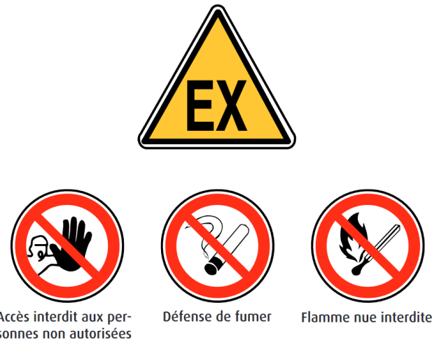
Figure 18 : Signalisation des zones ATEX et affichage de sécurité (Source : INERIS)
